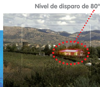
Sobreposição de imagem térmica em imagem visual
